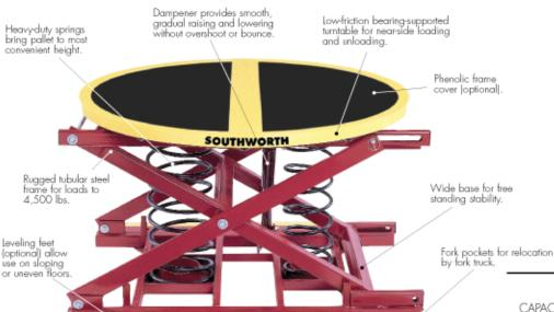
APPROX. LOWERED RAISED SHIPPING CAPACITY HEIGHT HEIGHT WEIGHT 28 460 ls. 400-4500 lbs
